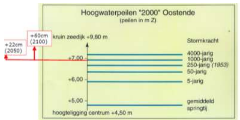
(figuur : de afname van het veiligheidspeil omwille van de zeespiegelstijging - naar Afdeling Kust, 2011)
