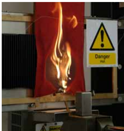
Flexiburn test voor de brandbaarheid van gordijnen.
