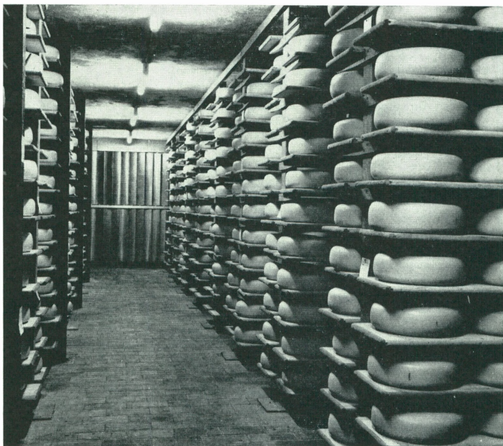
Rijpingslokaal van harde kaas, type Gouda. Warmte en vochtregeling geschieden automatisch
