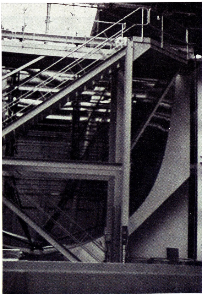
Proefmontage van een kielsegment
