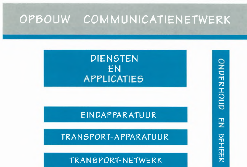
Figuur 1 Indeling in lagen van een communicatienetwerk
