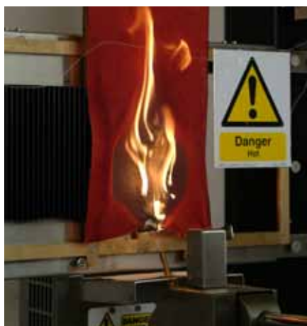
Flexiburn test voor de brandbaarheid van gordijnen.
