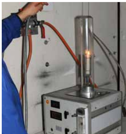
LOI Low Oxygen Index: dit toestel meet de zuurstofconcentratie die minimaal nodig is om een bepaalde stof te doen ontvlammen.
