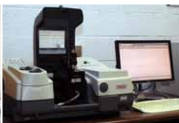
FTIR of Infrarood spectroscopie: analyse van de chemische samenstelling van producten.
