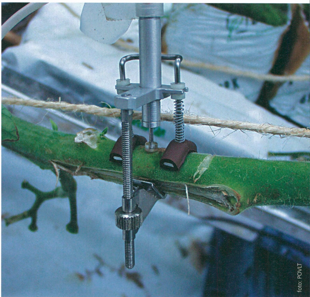
■ Watergiftesysteem met sensoren, waarbij de plant zelf de signalen genereert wanneer er water moet verstrekt worden. De ontwikkeling van deze zogenaamde 'sprekende plant' is bijna praktijkrijp voor serres.
