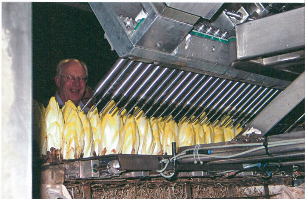
■ Een concreet voorbeeld van mechanisatie in de tuinbouwsector is deze witloof-oogstrobot.
